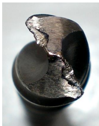
Рисунок 5.7 – Деформация рабочей части сверла в результате ослабления силы его закрепления
