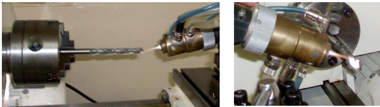
Рисунок 5.4 – Финишное плазменное упрочнение сверла
