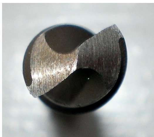
Рисунок 5.5 - Режущие кромки сверл до просверливания отверстий
